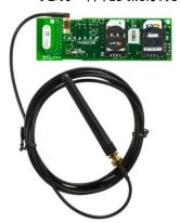
GPRS14 该模块可支持双卡(GSM)即支持两个不同的 GSM 网络运营商,在边境地区或者在移动航行的过程中,单一网络信号经常会很不稳定,所以在双卡双网络的支持下,可以做到通讯的无缝切换,下图为该模块的正面和反面的图片
